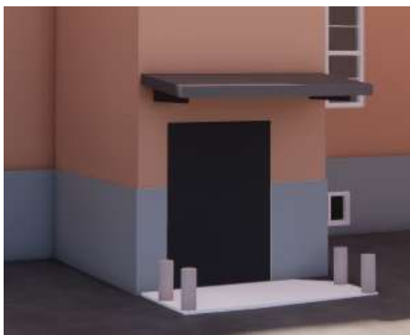
Figur 13: Inngangstak opplagt på innspente bjelker ut fra ramme.
